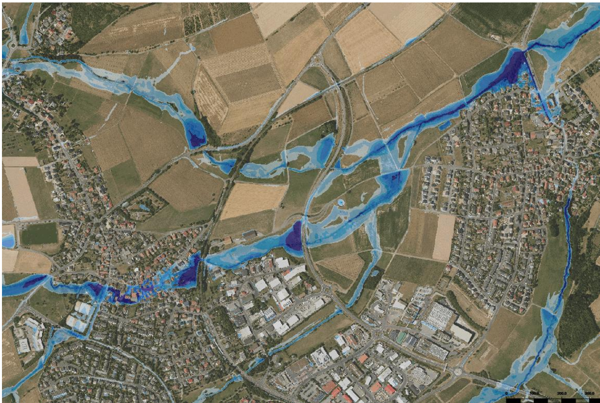
Abbildung 22: Ausschnitt der Simulationsergebnisse mit dem Höhepunkt der Überflutung
