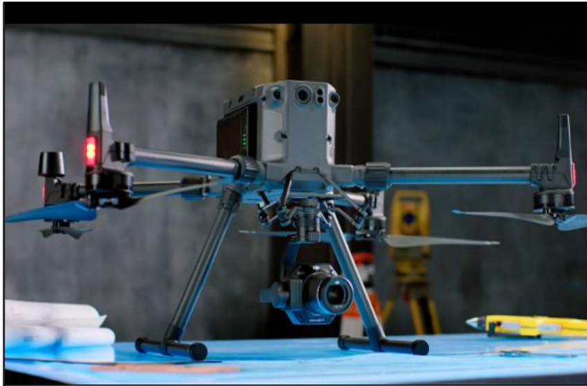
Abbildung 10: Vermessungsdrohne, Modell: DJI M300 RTK
