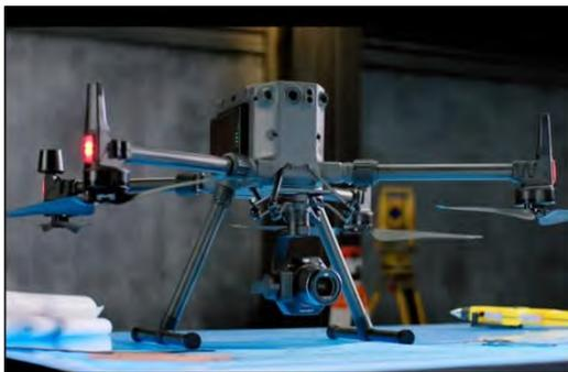
Abbildung 3: Vermessungsdrohne, Modell: DJI M300 RTK
